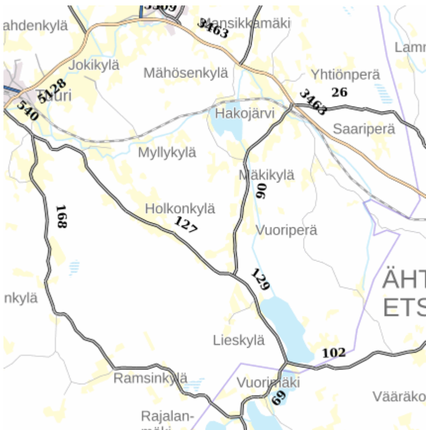
Kuva 13 Kartta alueen keskeisempien väylien keskimääräisestä vuorokauden liikennemäärästä. Harmaalla on osoitettu osuudet, joissa vuorokautinen liikenne on keskimäärin alle 1000 ajoneuvoa, sinisellä osuudet, jossa liikenne on keskimäärin 1000-3000 ajoneuvoa vuorokaudessa ja keltaisella 3000-6000 ajoneuvoa/vrk. (Väylävirasto, liikennemääräkarta, viitattu 26.3.2024)
